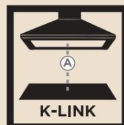
Gracias a la conexión por ondas de radio entre la campana y la placa Faber, la potencia de aspiración se regula automáticamente sobre la base del nivel de cocción seleccionado, optimizando la labor y evitando inútiles desperdicios.
