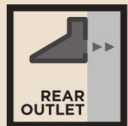
La salida de aire posterior permite canalizar el flujo de humos hacia la parte trasera de la campana, eliminando el tubo superior y disfrutando el espacio sobre el extractor.
