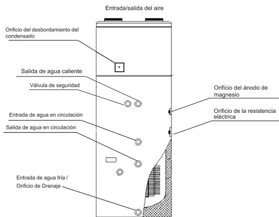
Conexión salida agua caliente: 3/4" macho
