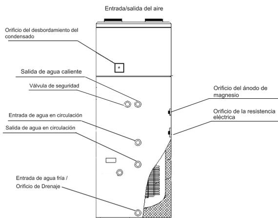
Conexión salida agua caliente: 3/4" macho
