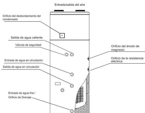
Conexión salida agua caliente: 3/4" macho
