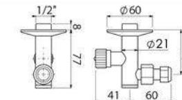
Instale nuestro Clean Filter para proteger las griferías contra posible suciedad y mejorar el flujo de agua. Clean filter debe ser instalado entre las dos válvulas de toma de agua y los tubos flexibles de la propia grifería.
