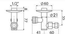
Instale nuestro Clean Filter para proteger las griferías contra posible suciedad y mejorar el flujo de agua. Clean filter debe ser instalado entre las dos válvulas de toma de agua y los tubos flexibles de la propia grifería.
