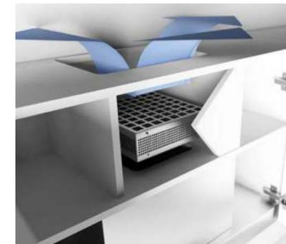
Extrae el aire por todo su perímetro reduciendo así la fricción y la presión, por esta razón, para una buena circulación del aire a la salida de los filtros se recomienda dejar un mínimo de 30 mm. entre el filtro y el tubo decorativo o el cajead.
