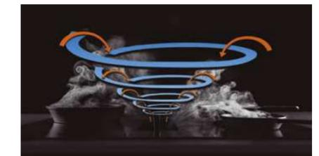
La Zona de aspiración de la Flow 5 gracias a su diseño, produce un flujo de aire de alta velocidad generando un efecto de atracción que se amplía a mayor altura atrayendo los humos hacia el centro y llevándolos hacia su interior.
